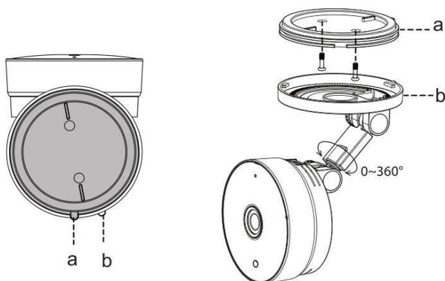
步驟 1：旋轉攝影機的底座，直到點 a 和 b 對齊，這樣可以卸下安裝板。
