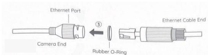
4. 將防水連接器與乙太網路端口對齊，接著擰緊頂蓋，並鎖緊到位就完成安裝。
