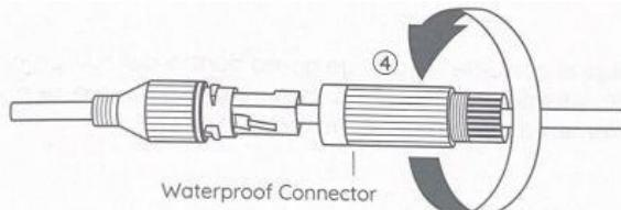
5. 將橡膠密封圈推到防水接頭，接著擰緊頂蓋，並鎖緊到位就完成安裝。
