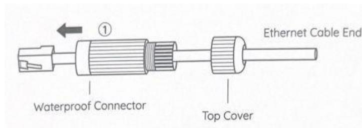
2. 用橡膠密封圈套在頂蓋和防水連接器中間的乙太網路線上。
