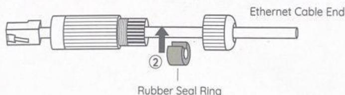
注意: 橡膠密封圈已有切割過。若沒有, 可以自行切割。
